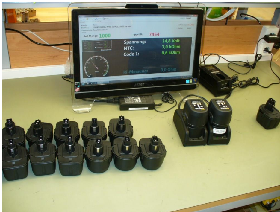
Obr. 16: Měření a testování akumulátoru [zdroj: výrobní společnosti BAP]
