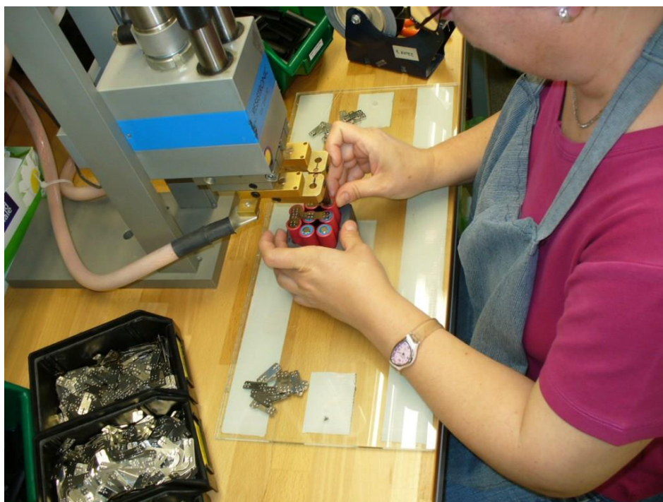
Obr. 11: Sváření akubloku [zdroj: výrobní společnosti BAP]
