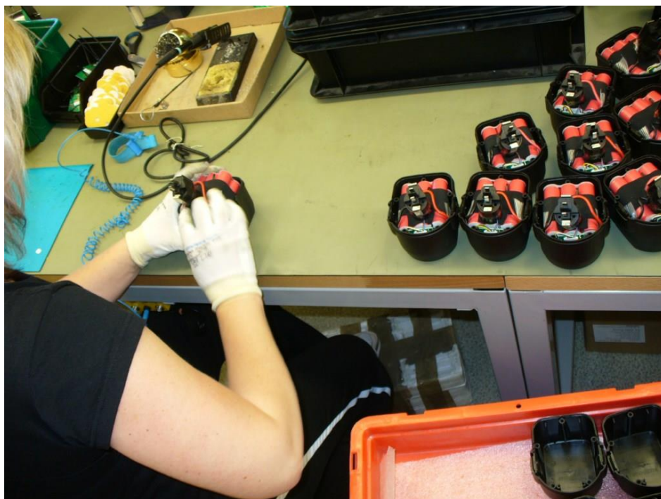
Obr. 14: Vložení akubloku do obalu [zdroj: výrobní společnosti BAP]
