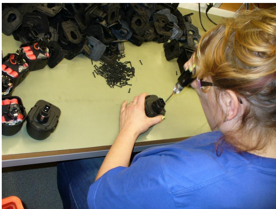
Obr. 15: Zašroubování Li-Ion akumulátoru [zdroj: výrobní společnosti BAP]
