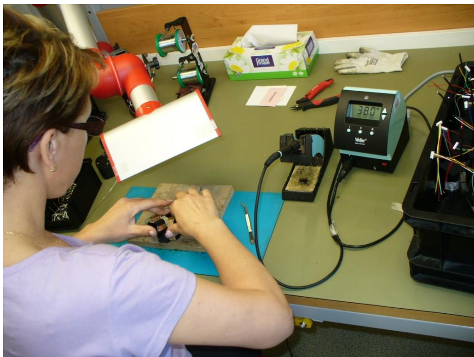
Obr. 12: Příprava kontaktní hlavy [zdroj: výrobní společnosti BAP]
