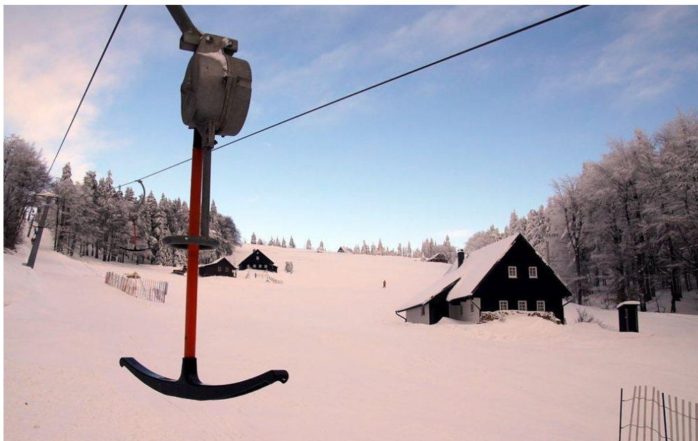
Obr. 14 - Lyžařský vlek s vysokým vedením lana – kotva [14]
