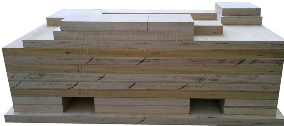
Obr. 9. Slepeneček kopyta před obráběním.
