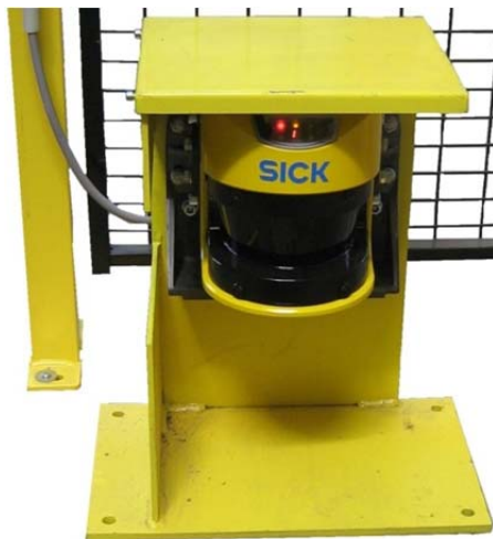
Obr. 90. Optoelektronický skener značky SICK. [N]
