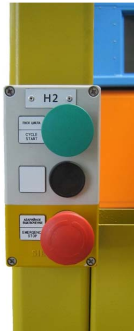
Obr. 93. Ovládání pracovního procesu stroje (otáčení / sklápění). [N]
