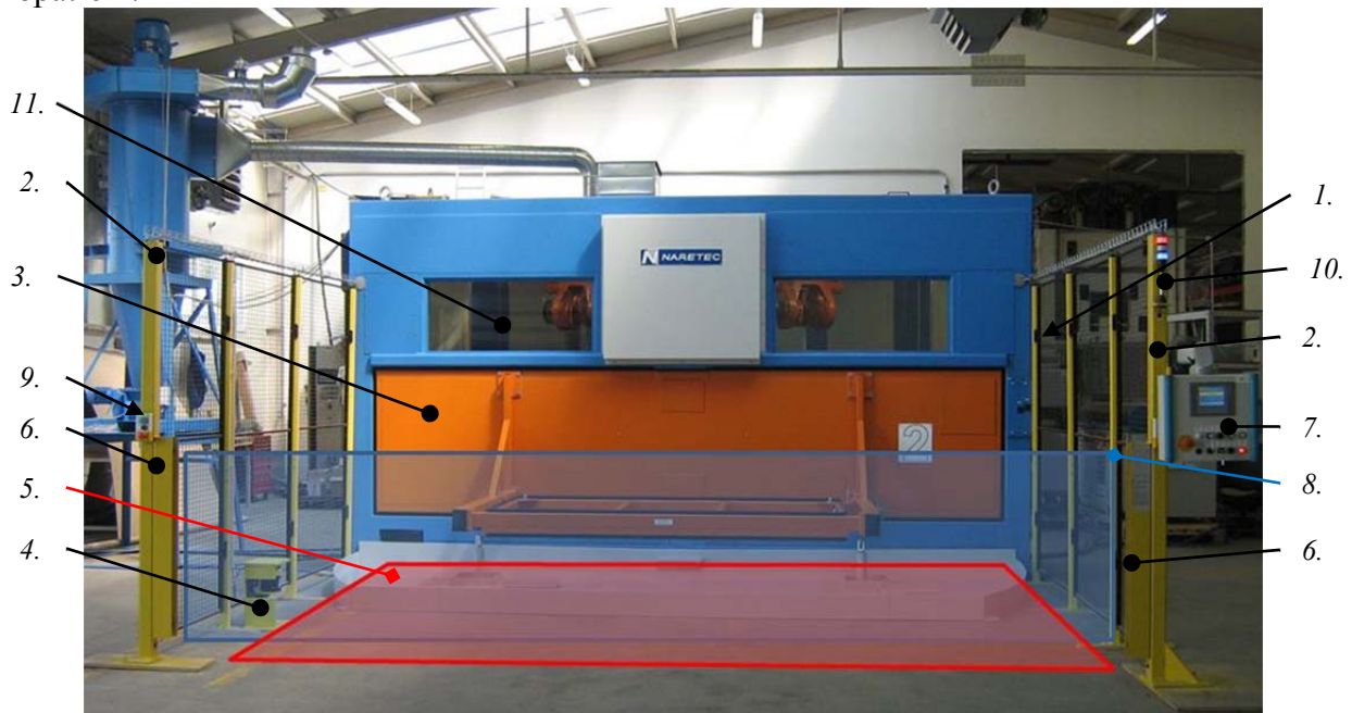
1-Umístění vstupních dveří kabiny, 2-Mechanické zábrany (Plot), 3-Otočné křídlo, 4-Skener, 5-Pracovní prostor, sledovaný skenerem, 6-Světelný závoj, 7-Ovládací panel stroje, 8-Prostor uzavřený světelným závojem, 9-Ovládání procesu otáčení stroje, 10-Světelná signalizace, 11-Prostor vně kabiny.
