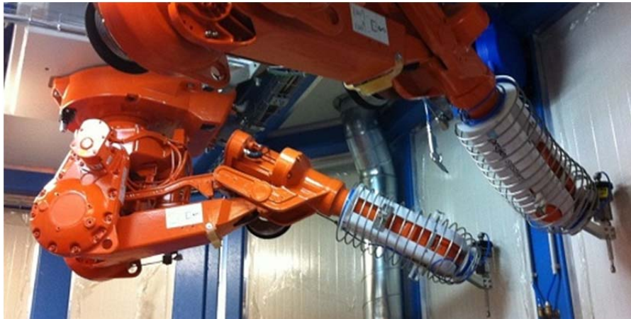
Obr. 6. Robot značky ABB s řezací vodní hlavou.[4]
