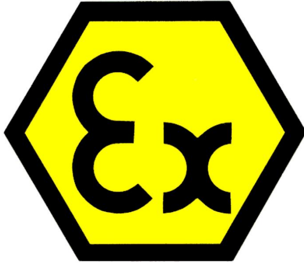
Obrázek 5: Označení stroje pro práci ve výbušných atmosférách. [4]
