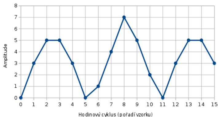
Obrázek 2.7: Generovaný průběh pro fázový inkrement odpovídající číslu 3
