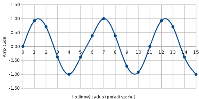
Obrázek 2.5: Generovaný průběh pro fázový inkrement 3
