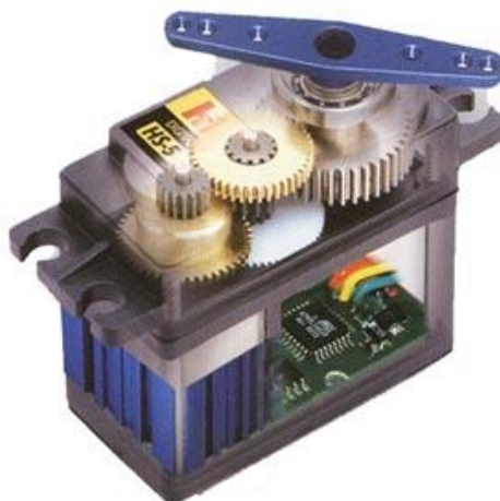
Obrázek 5.2 : Řez modelářským servomotorem
