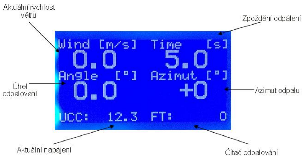
Obrázek 7.2 : Popis grafického displeje použitým na ovládacím pultu
