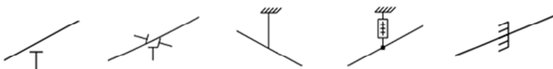
Obrázek 13 Symboly používané pro uložení – podpěra, kluzná podpěra, pevný závěs, pružinový závěs a pevný bod (kotvení).
