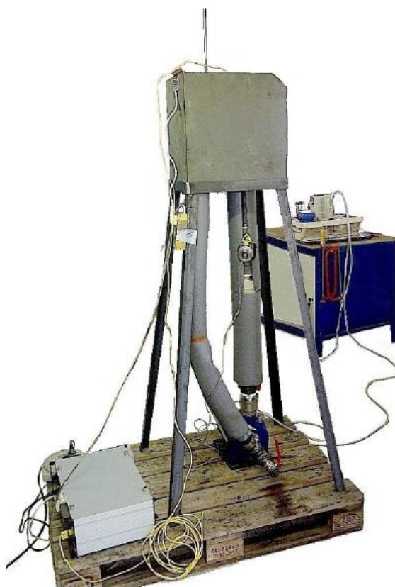
Obr. 16 Kompletní sestava experimentálního zařízení se zapojenými měřicími a regulačními přístroji (regulace teploty, měřič průtoku, frekvenční měnič) [14]
