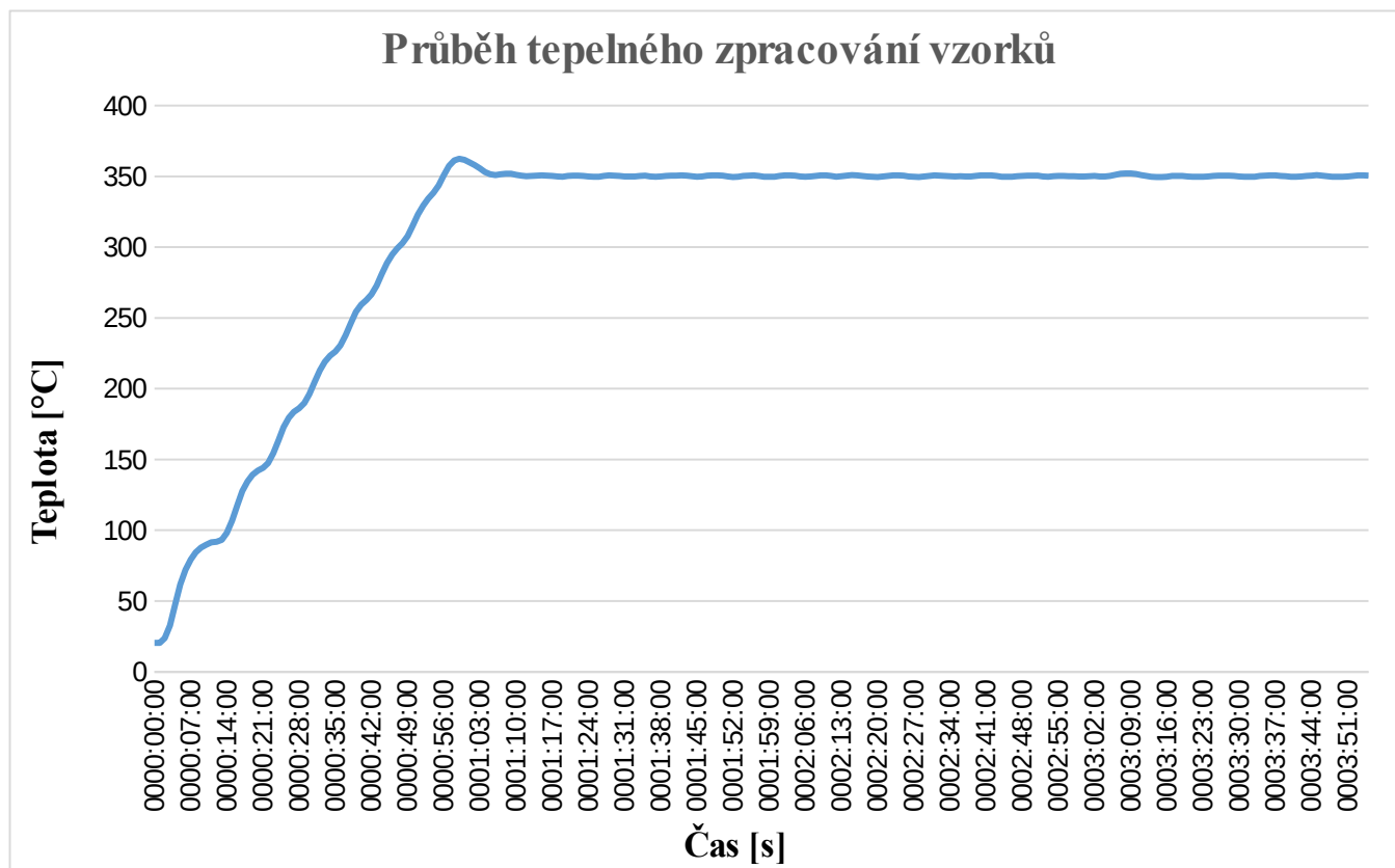
Obr. 17 – Průběh tepelného zpracování všech vzorků
