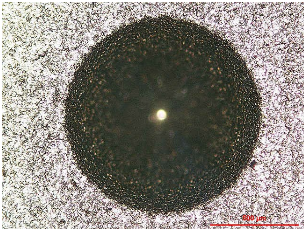
Obr. 39 – Vzorek č. 1 (0g UDDG v lázni). Odpovídá HF1. Praskliny byly zřetelné pouze v SEM.
