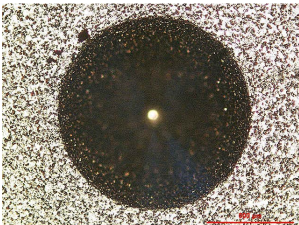
Obr. 43 – Vzorek č. 5 (0,5g UDDG v lázni). Odpovídá HF1. Praskliny jsou viditelné pouze při velkém zvětšení v SEM.
