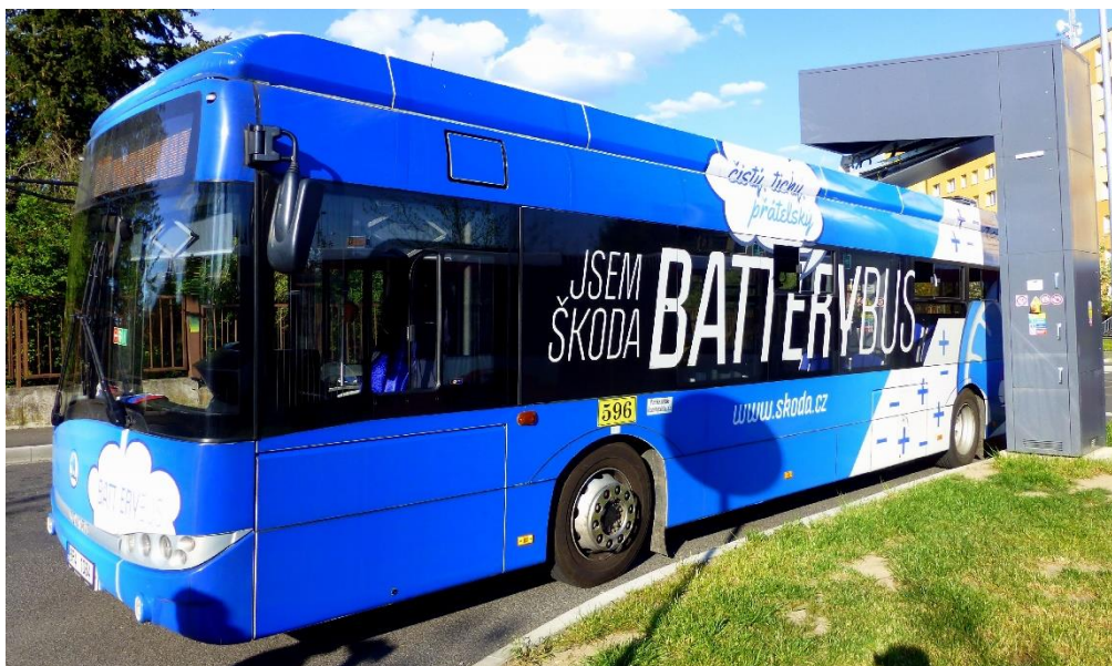
Obr. 2.4 Škoda Perun 26BB HP při rychlonabíjení v obratišti
