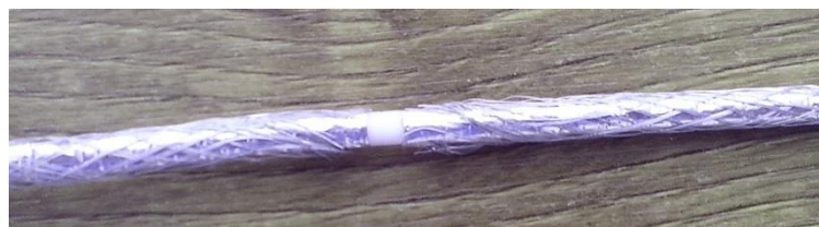
obr. 19: Obnažená část stínění
