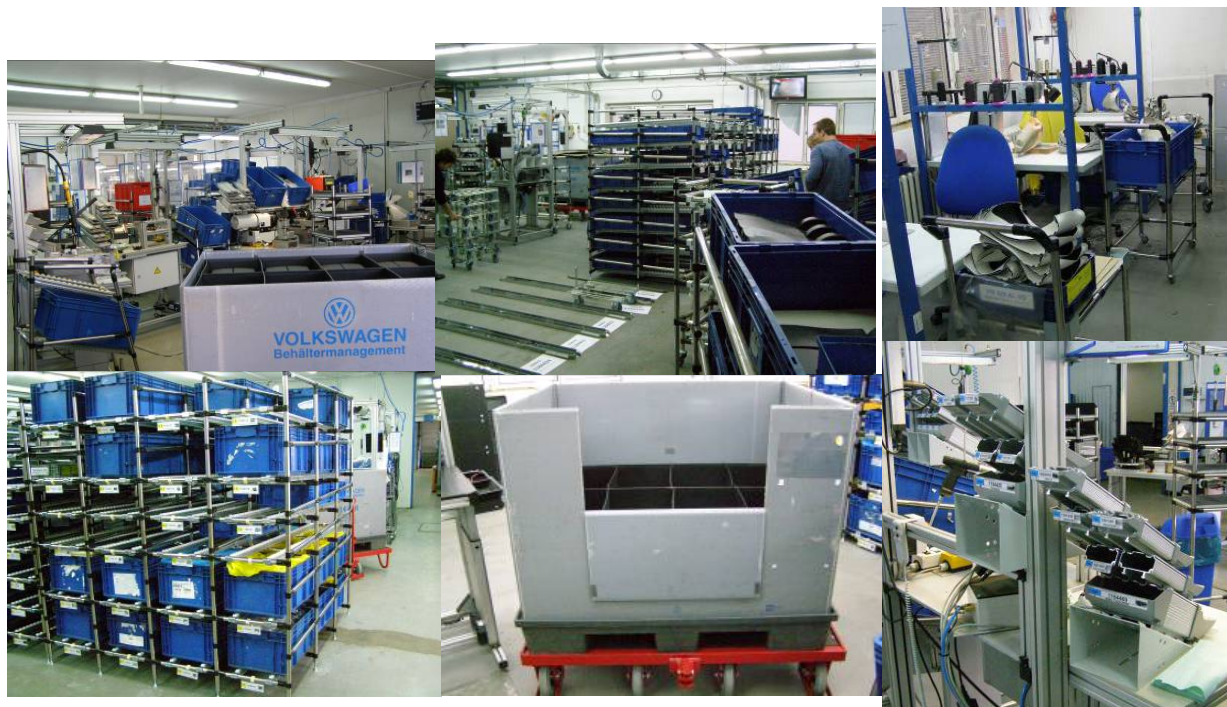
Obrázek 7-2 Ukázka některých implementovaných věcí na linku MAL VW526VO – Touareg, bambusové regály, průběžné kolejnice + Visual management, pracoviště šicí, Supermarket, manipulační vozíky pro Milkrun a průběžné zásobníky na materiál
