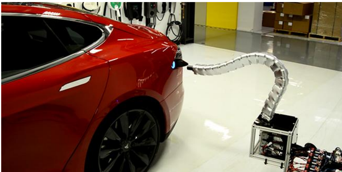
Obr. 1.9 Prototyp automatického připojení drátového konektoru od firmy Tesla [16]
