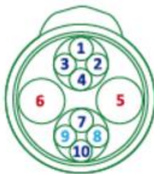
Obr. 2.2 Rozmístění pinů CHAdeMO konektoru [12]
