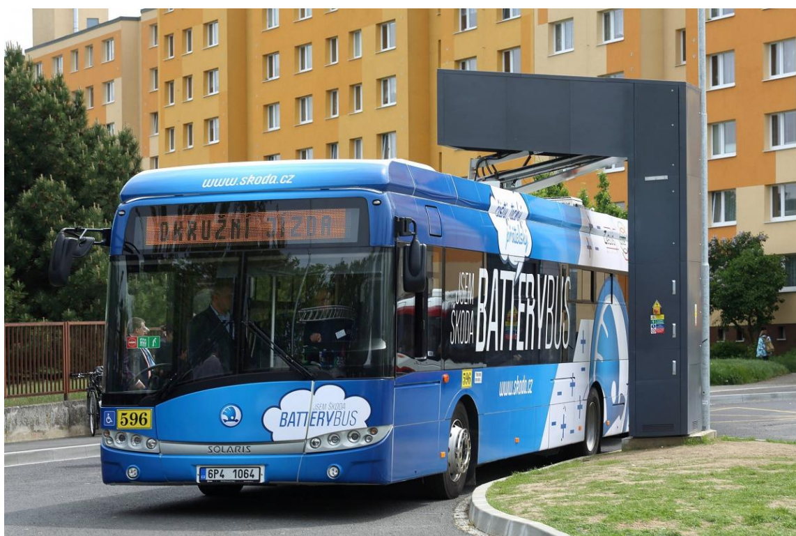
Obr. 1.8 Rychlonabíjení elektrického autobusu Škoda Perun HP [9]
