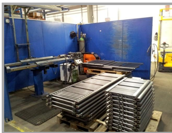
Obrázek 3-8 Pracoviště bodového svařování
