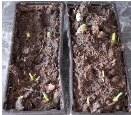
Obrázek 15: Vzorok po druhém zalití, vlevo vzorek samotné půdy, vpravo vzorek s hydrogelem (Zdroj: vlastní)
