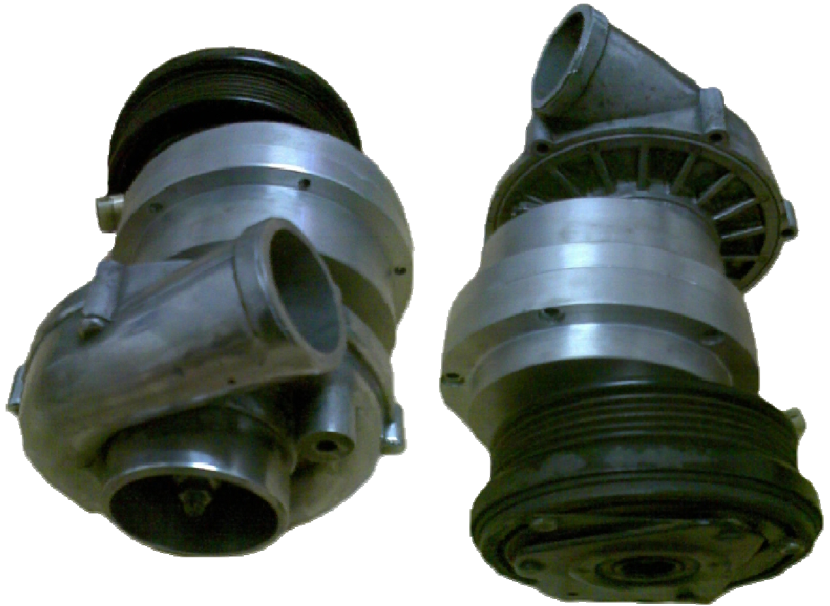
Obr. 14 – Mechanické řešení kompresoru s elektromagnetickou spojkou
