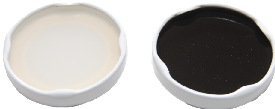
Obr. 12 – Náhled na hmoty použité k zalévání Vlevo Lukopren S5296, vpravo Polyuretan PU309
