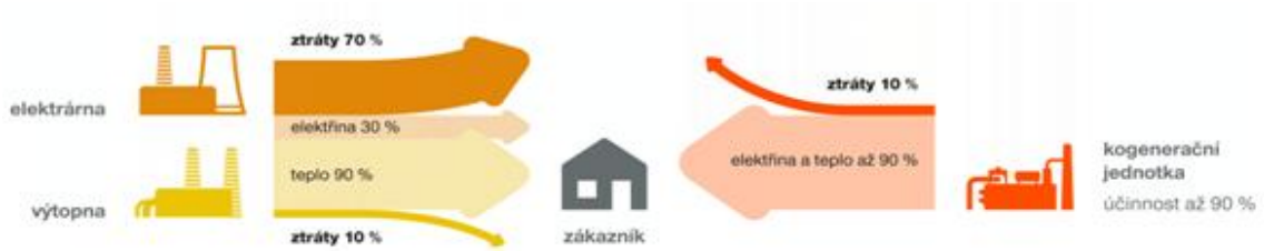
Obrázek 5.1: Porovnání účinností oddělené výroby elektřiny a tepla a KVET
