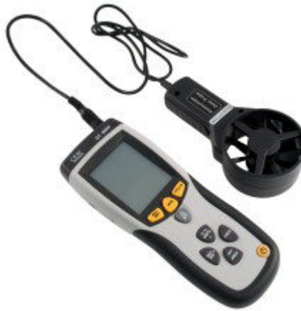
Obr. 9: Thermo Anemometr CEM DT-8894 [převzato z 21]
