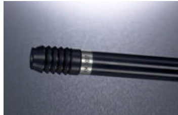
Obr. 12: Sonda pro měření vlhkosti [převzato z 17]
