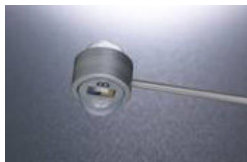
Obr. 13: Sonda pro měření zářivé teplotní asymetrie [převzato z 17]
