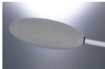
Obr. 16: Sonda pro měření suché tepelné ztráty a operativní teploty [převzato z 17]
