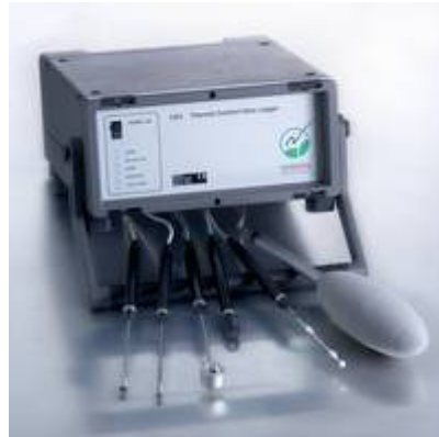
Obr. 10: Snímač INNOVA (dříve Brüel & Kjaer) 1221 [převzato z 17]
