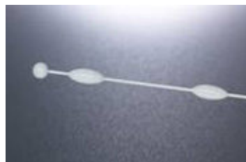
Obr. 11: Sonda pro měření proudění vzduchu [převzato z 17]
