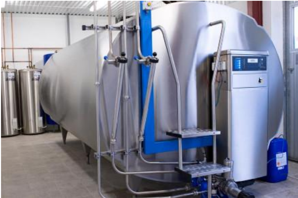
Obr. 2.3 Uzavřený chladicí tank na mléko typ DXCE [4]
