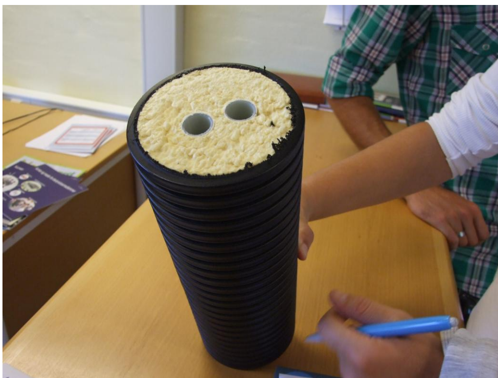
Obr. 4.17 Trubky sloužící pro transport teplé vody k odběratelům a zpět do provozu
