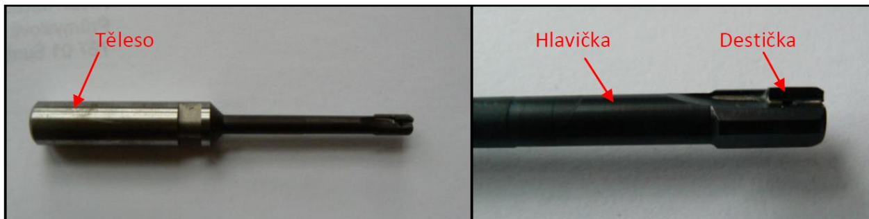
Obr. 25 Prototypový výstružník s pájenou cermetovou destičkou
