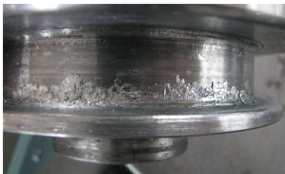
Obr. 34 Nalepování zinku na nástroj při lemování [Zdroj:18]
