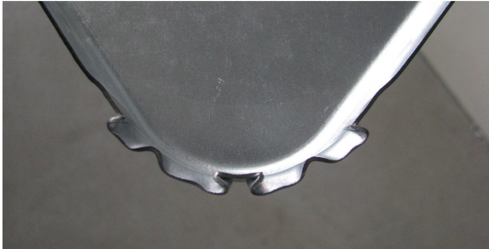
31c. Vznik vln při lisování bez přídržovače[Zdroj:18]
