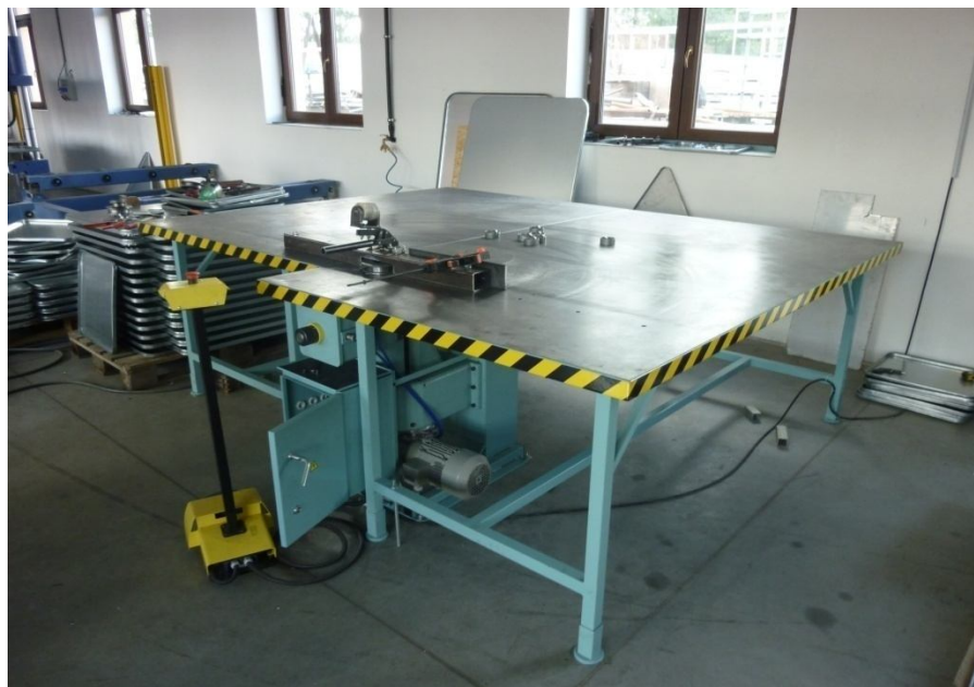
Obr. 10 Lemovací stroj [Zdroj: 18]
