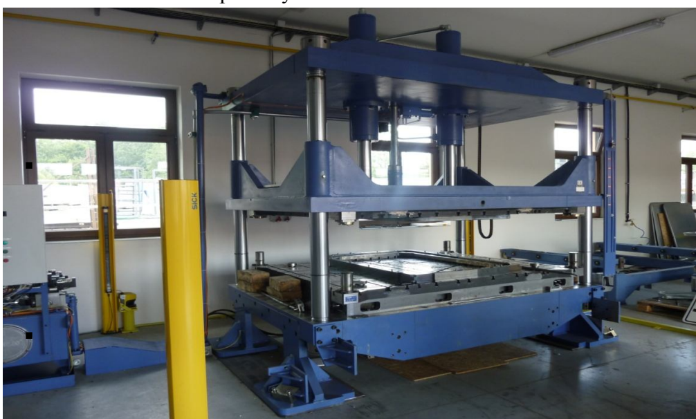
Obr. 9 Hydraulický lis [Zdroj: 18]
