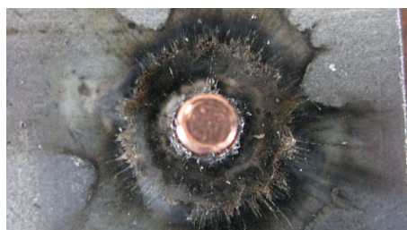
Obr.35 Rozstřík povrchové vrstvy zinku při působení nadměrného tepla [Zdroj:18]
