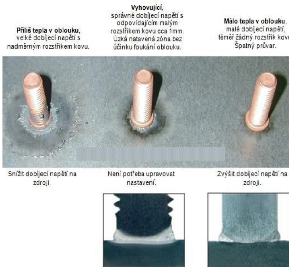
Obr. 41 Ukázka ideálního spoje uprostřed [Zdroj:20]
