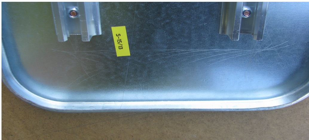
Obr. 4 Dvojitý ohyb štítu [Zdroj: 18]
