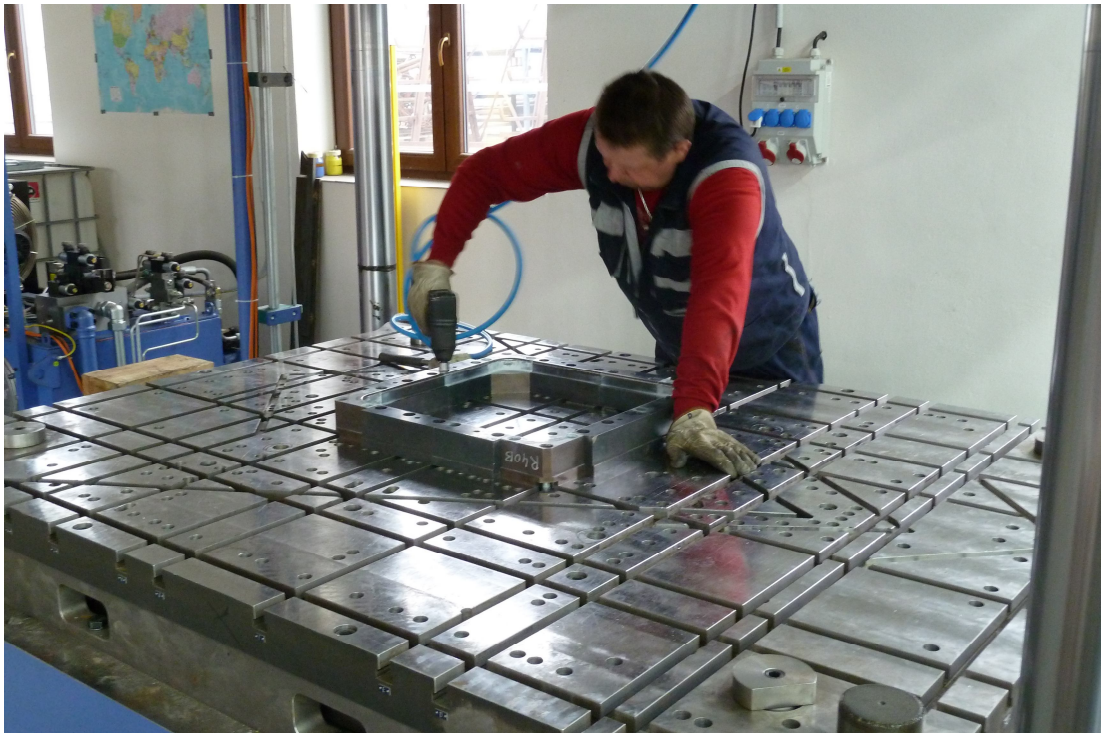
Obr. 26 Montáž tažnice na spodní matici [Zdroj: 18]
