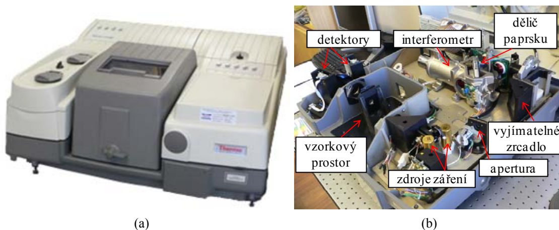
Obr. 12: FTIR spektrometr Nicolet 6700 – (a) konfigurace; (b) vnitřní uspořádání.
