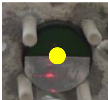
Obr. 48: Poloha a velikost oblasti definované spektrometrem na povrchu vzorku (vyznačeno žlutě).
