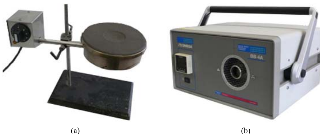
Obr. 13: Referenční zdroje záření – (a) topná deska SH 15; (b) komerční černé těleso BB-4A-230.
