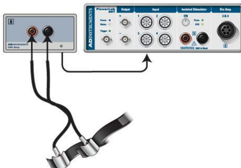
Obrázek 8 - Schematické znázornění měřicího přístroje ADINSTRUMENT Power Lab spolu se zesilovačem ML 116 GSR Amp a elektrodami (Benešová 2011).
