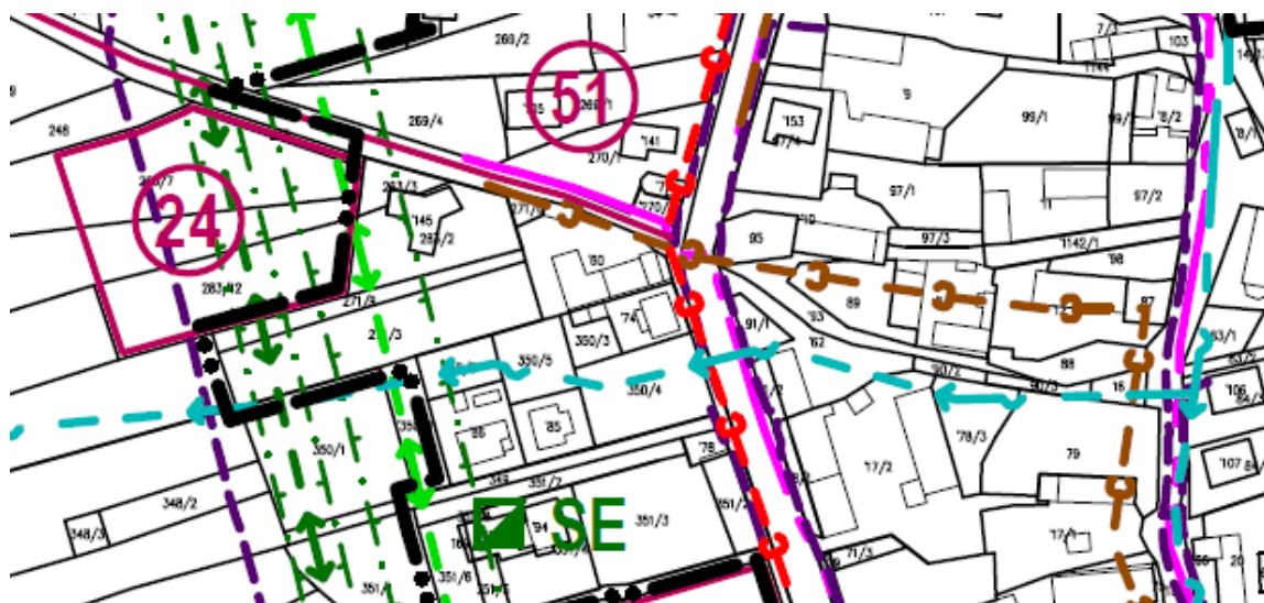
Obr. 3. 12 Výřez výkresu Koncepce technické infrastruktury se zakreslením vedení uvnitř zástavby: vodovod (modrá linie), elektřina (sv. zelená linie - 110kV, tm. zelená linie - 22kV), středotlaký plynovod (ružová linie), kanalizace (hnědá linie – stávající, červená linie – navrhovaná), měřítko - 1:10 000.
