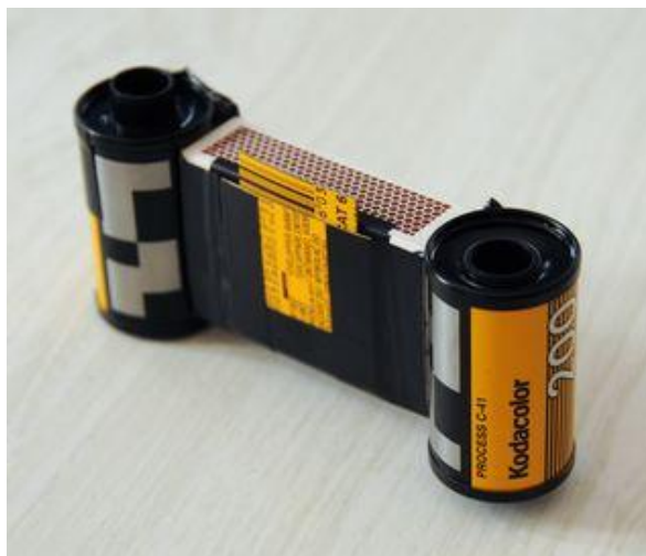
Obrázek 17 Pinhole z krabičky od sirek
