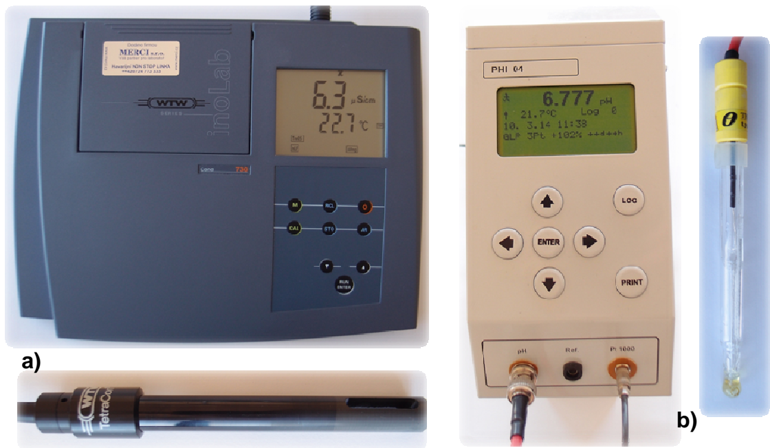
Obr. 34: Přístroje a sondy pro měření elektrické vodivosti a pH.
