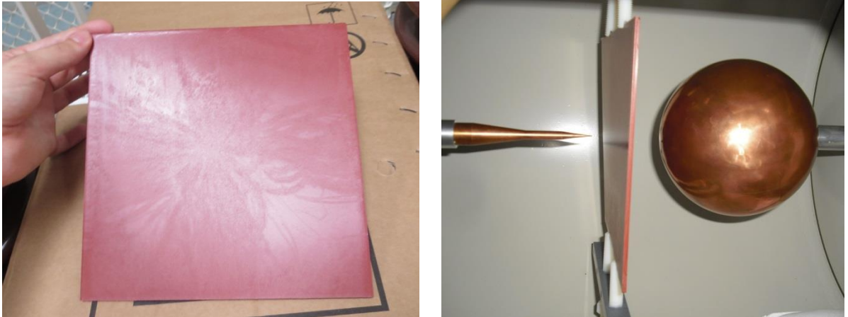
Obr. 3.7 Bariéra – vlevo mimo nádobu, vpravo mezi elektrodami
