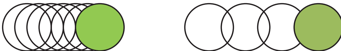
Obr. 4 Překrývání výplně v závislosti na rychlosti, průměr spotu 70 \mu\text{m} ; f=25\text{ kHz} ; rychlost posuvu vlevo 500 mm/s, vpravo 2000 mm/s
