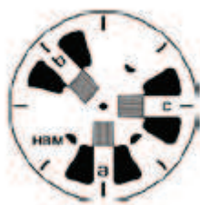
Obr. 13 Schéma růžice HBM 0^{\circ}/45^{\circ}/90^{\circ} [21]
