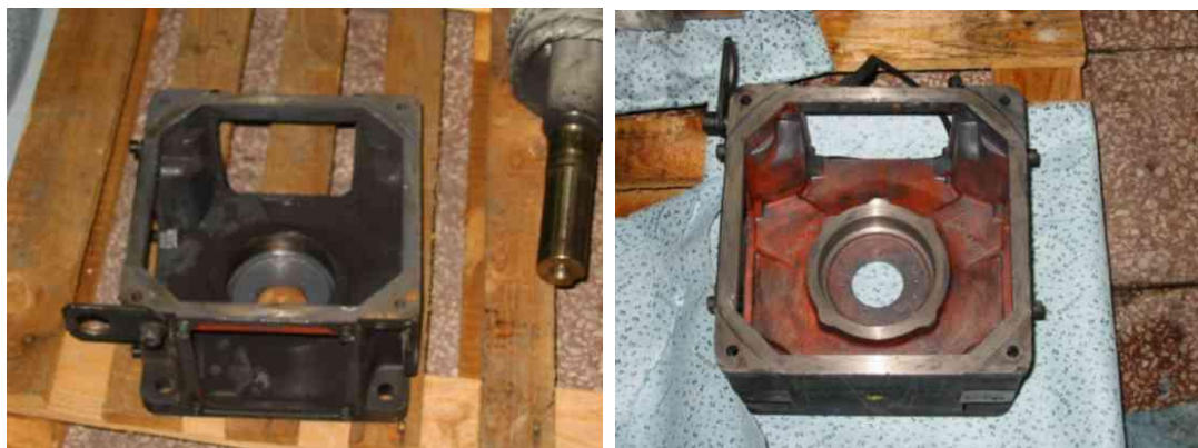
Obr. 6 Kovový kryt před a po aplikaci CT Technologie (převzato z: [19])
