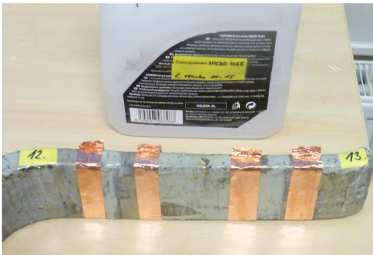
Obr. 15 Čelo vinutí s vytvořenými elektrodovými systémy a barevným značením
