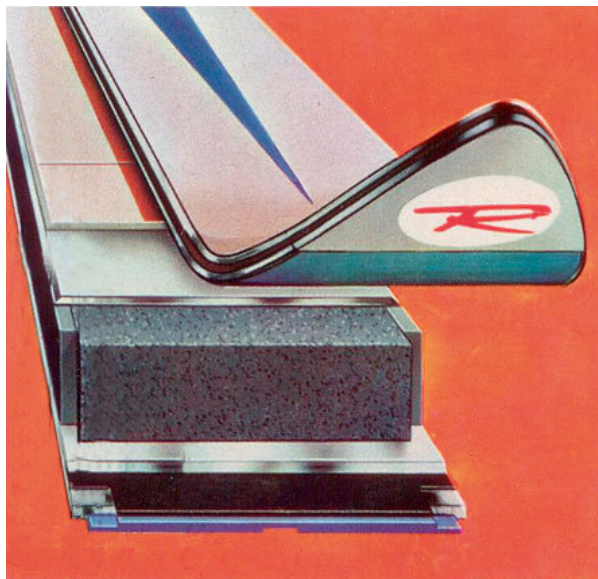
Obrázek 1: Průřez plastovou lyží Rossignol ROC 550. [31]
