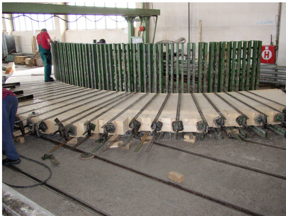
Obrázek 2.1 Lisování a lepení obloukového nosníku (ČDZ Praha, a.s.)
