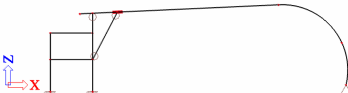
Obrázek 4.13 Návrh nového modelu konstrukce se vzpěrou
