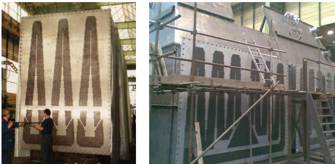
Obr. 4: Ukázka provedení trubkových svazků kondenzátoru, interní zdroj DOOSAN ŠKODA POWER, s.r.o., [8].
