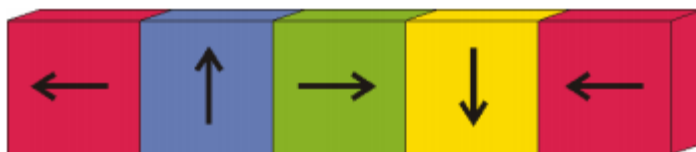
Obr. 18 - Halbachova soustava uspořádání permanentních magnetů [11]
