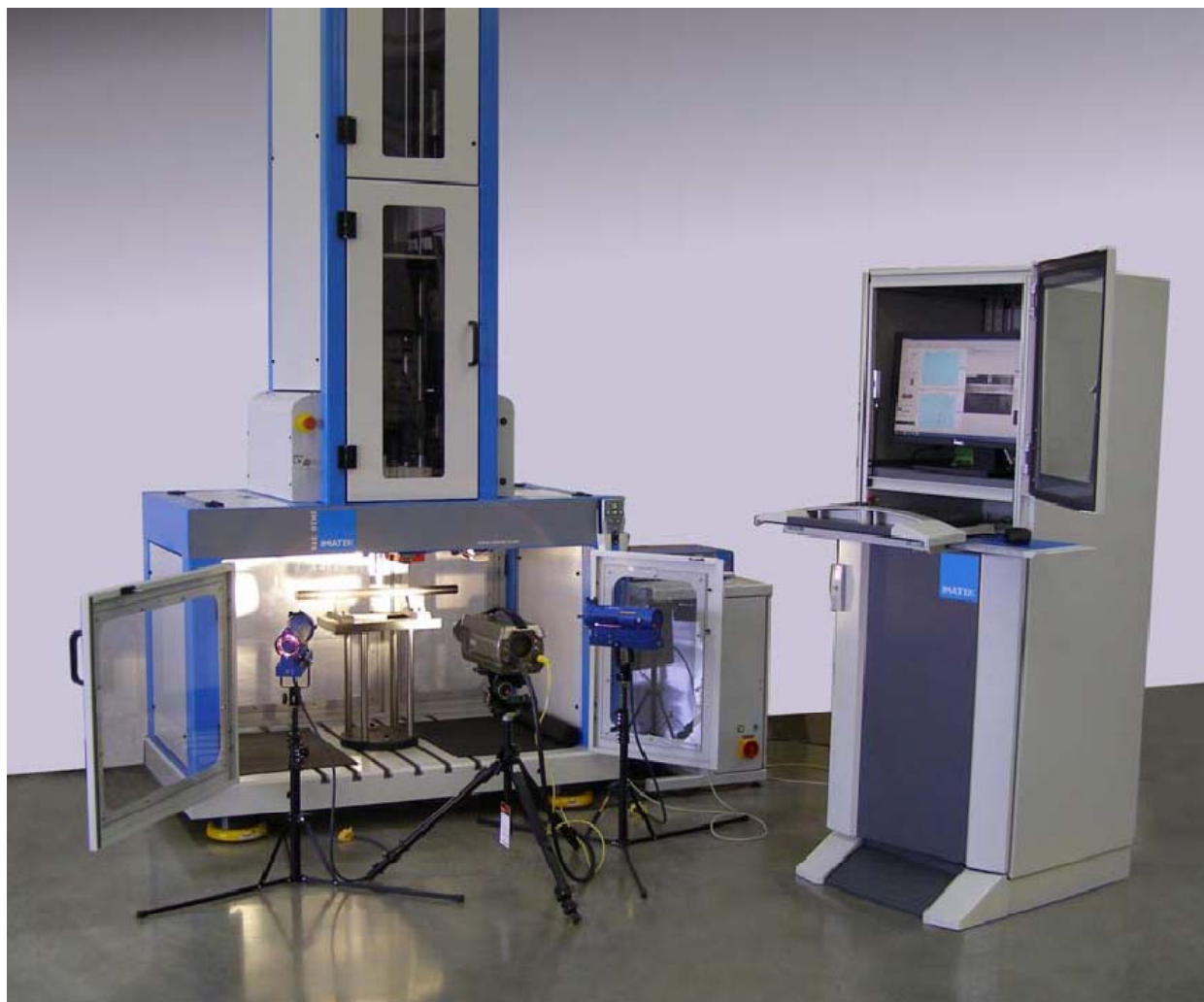
obr. 3 - padstroj Imatek IM10T-30HW s řídicí stanicí a rychlostní kamerou
