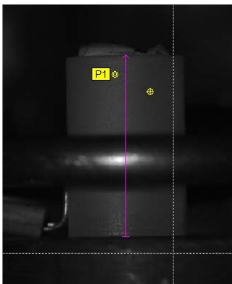
obr. 43 – P1 – bod na vzorku, čára kalibrace
