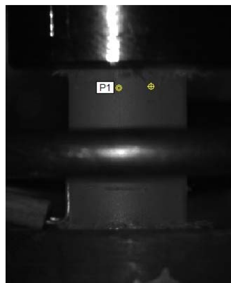
obr. 44 – posunutí bodu při deformaci
