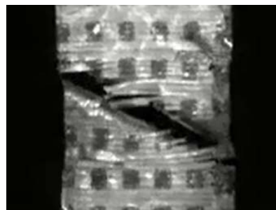
obr. 12 - tah – potažený plech
