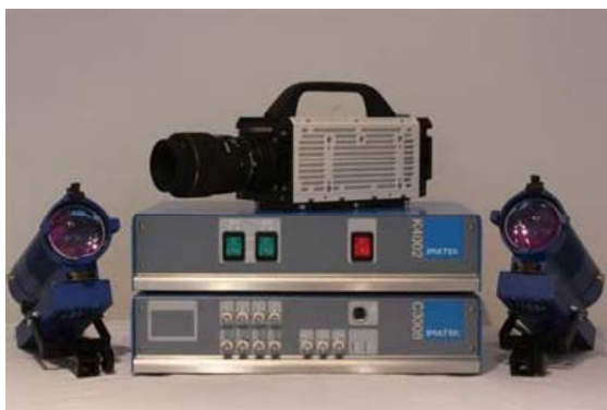
obr. 9- rychlostní kamera s osvětlením a synchronizačním zařízením
