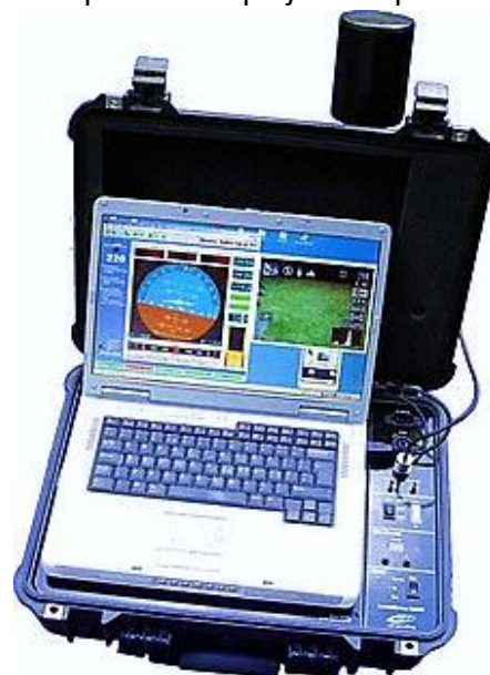
Obrázek 20 – ovládací stanice pro SensoCopter
