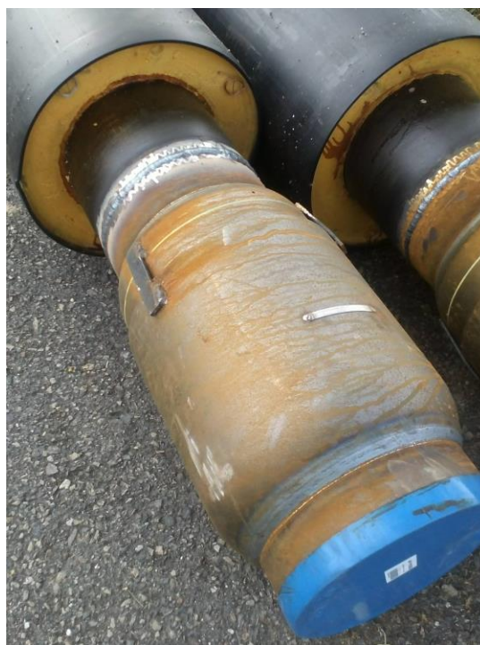
Obr. 3 - Pohled na svarovou mezeru předizolované trubky
