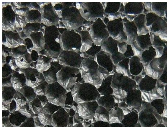
Obr. 4 - Detail uzavřené makrostruktury kaučukové pěny
