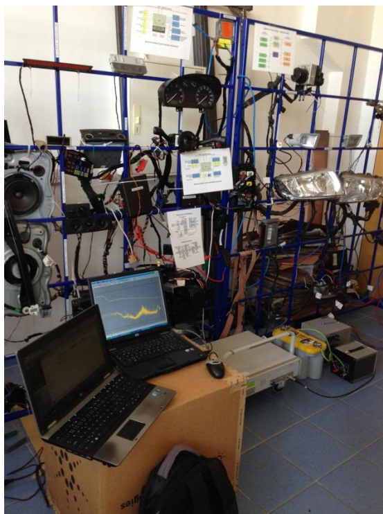
Obr. 5.2.1 Měření rušení po vedení v laboratoři elektrotechnické fakulty
