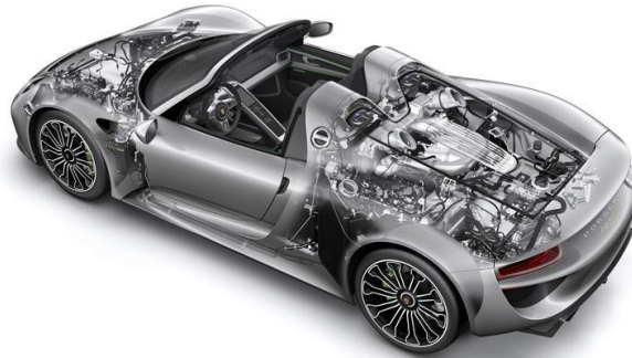
Obr. 1.5.1 Porsche 918 Spyder, poháněné kromě spalovacího motoru dvěma elektromotory, představující vozidlo s velkým množstvím nemodernějších elektrických a elektronických systémů [9]
