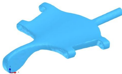
Obrázek 21: Model odlitku klapky KLG 119 98_nasnímaný pomocí 3D scanneru [vlastní zdroje]
