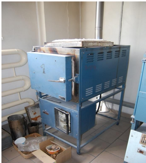
Obrázek 5: Komerová vypalovací pec, kde je průběh teploty řízen pomocí vačkového mechanismu [vlastní zdroj].
