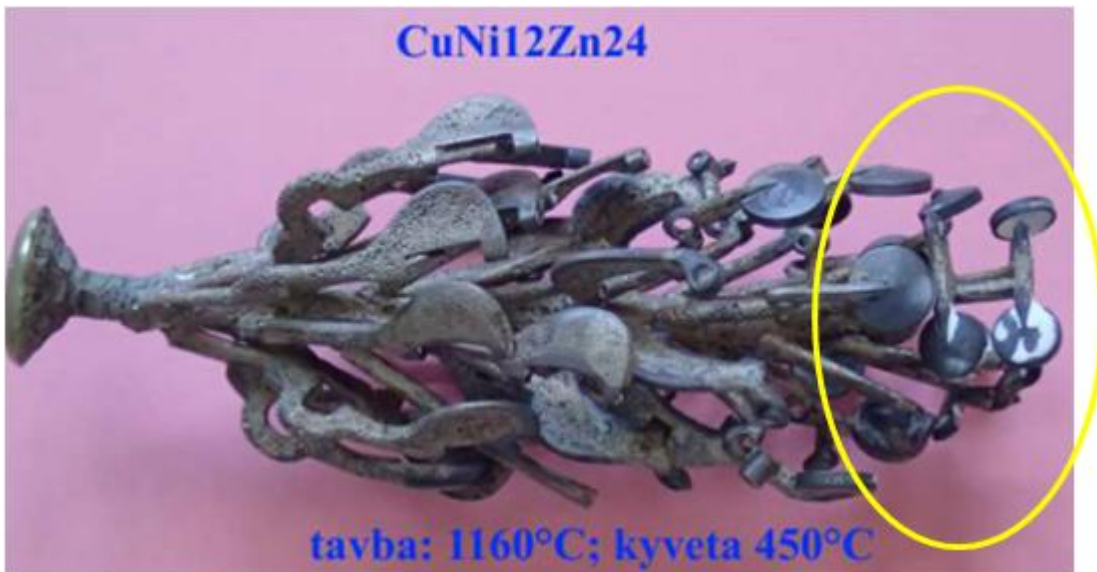
Obrázek 85: Ze stromečku z tavby slitiny CuNi12Zn24, byly odříznuty vzorky z horní, střední a spodní části stromečku. Žlutým kroužkem je označena oblast odebrání třetího vzorku (spodní část stromečku). [vlastní zdroje]
