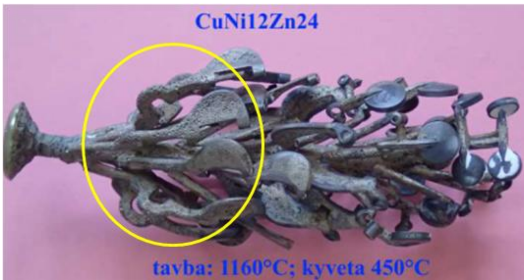
Obrázek 71: Ze stromečku z tavy slitiny CuNi12Zn24, byly odříznuty vzorky z horní, střední a spodní části stromečku. Žlutým kroužkem je označena oblast odebrání prvního vzorku (horní část stromečku). [vlastní zdroje]
