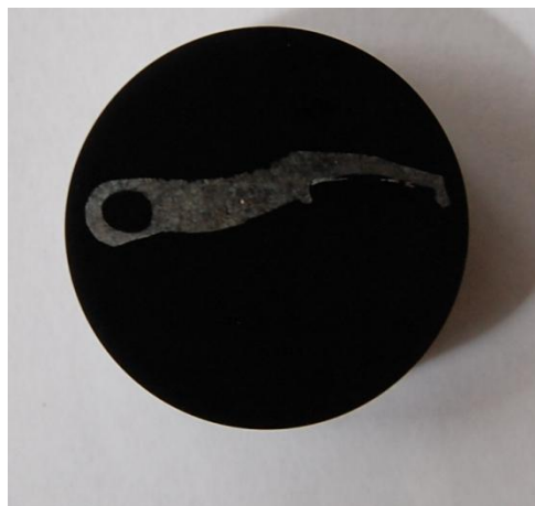
Obrázek 86: Spodní část stromečku, po zalití a naleptání připravená pro metalografii a měření mikrotvrdomosti [vlastní zdroje]
