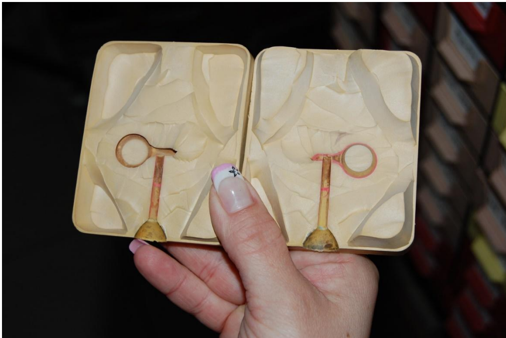
Obrázek 1: Forma používaná k výrobě vytavitelného modelu- materiál formy silikonový kaučuk[vlastní zdroje].
