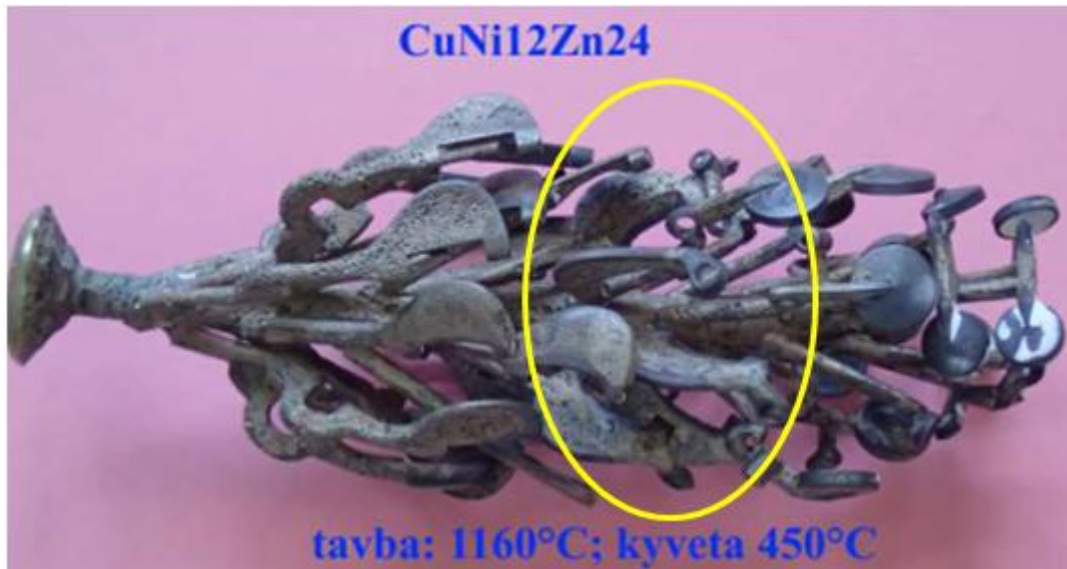
Obrázek 78: Ze stromečku z tavby slitiny CuNi12Zn24, byly odříznuty vzorky z horní, střední a spodní části stromečku. Žlutým kroužkem je označena oblast odebrání druhého vzorku (střední část stromečku). [vlastní zdroje]
