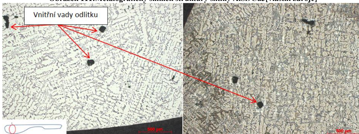
Obrázek 112: Metalografický snímek struktury slitiny AlSi9Cu3 [vlastní zdroje]
