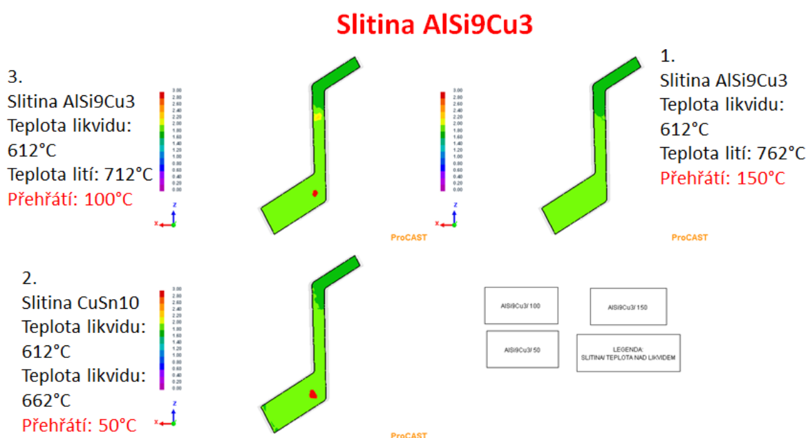
Obrázek 45: Příklad poréznosti slitiny AlSi9Cu3, který ukazuje vliv velikosti přehřátí slitiny na velikost a rozložení poréznosti v odlitku typu KL 119 98 [vlastní zdroje]
