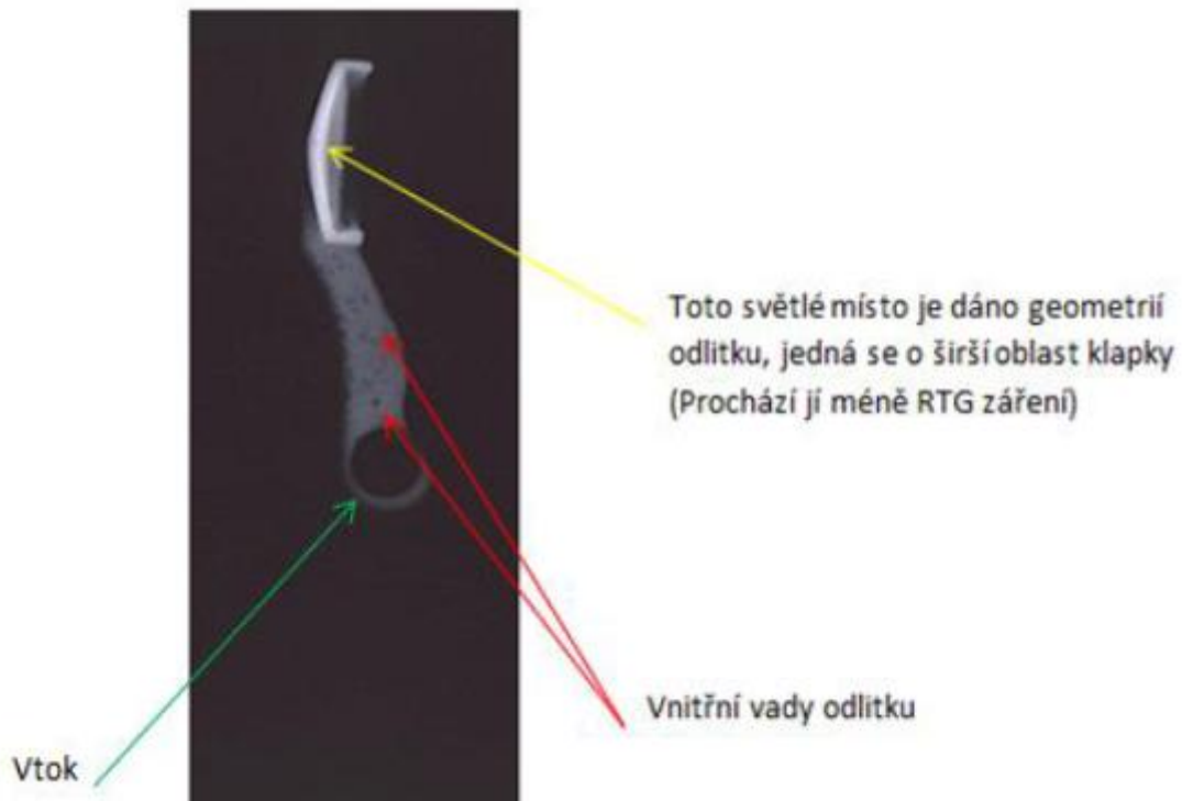
Obrázek 30: Rentgenový snímek vzorku CuNi12Zn24 (spodní část), vady se nacházejí za zúženou, v rozšířené, části odlitku. V této oblasti má kov zhoršenou dosazovací schopnost, díky čemuž mohou vznikat řediny. Náprava je možná například nálitkováním v blízkosti výskytu popřípadě umístěním dalšího vtoku. [vlastní zdroje]
