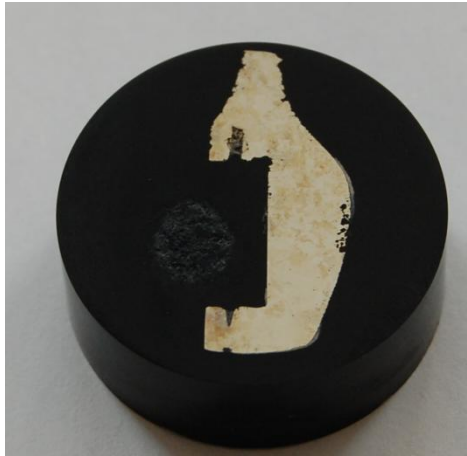
Obrázek 72: Horní část stromečku, po zalití a naleptání připravená pro metalografii a měření mikrotvrdotí[vlastní zdroje]
