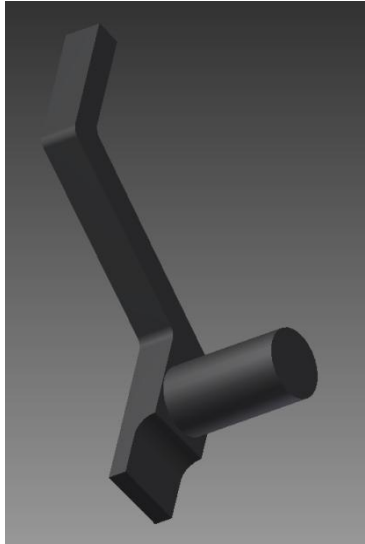
Obrázek 56: Klapka typ KL 119 98- umístění zářezu pro stanovení vlivu tloušťky zářezu na jakost odlitku[vlastní zdroje]
