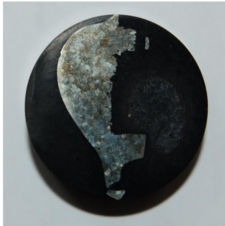
Obrázek 79: Střední část stromečku, po zalití a naleptání připravená pro metalografii a měření mikrotvrdoti [vlastní zdroje]
