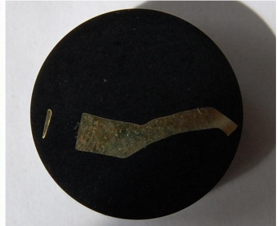
Obrázek 97: Vzorek CuZn30 KL119 98, zalitý do formovací hmoty po naleptání (vzorek určený pro metalografii a mikrotvrdost) [vlastní zdroje]
