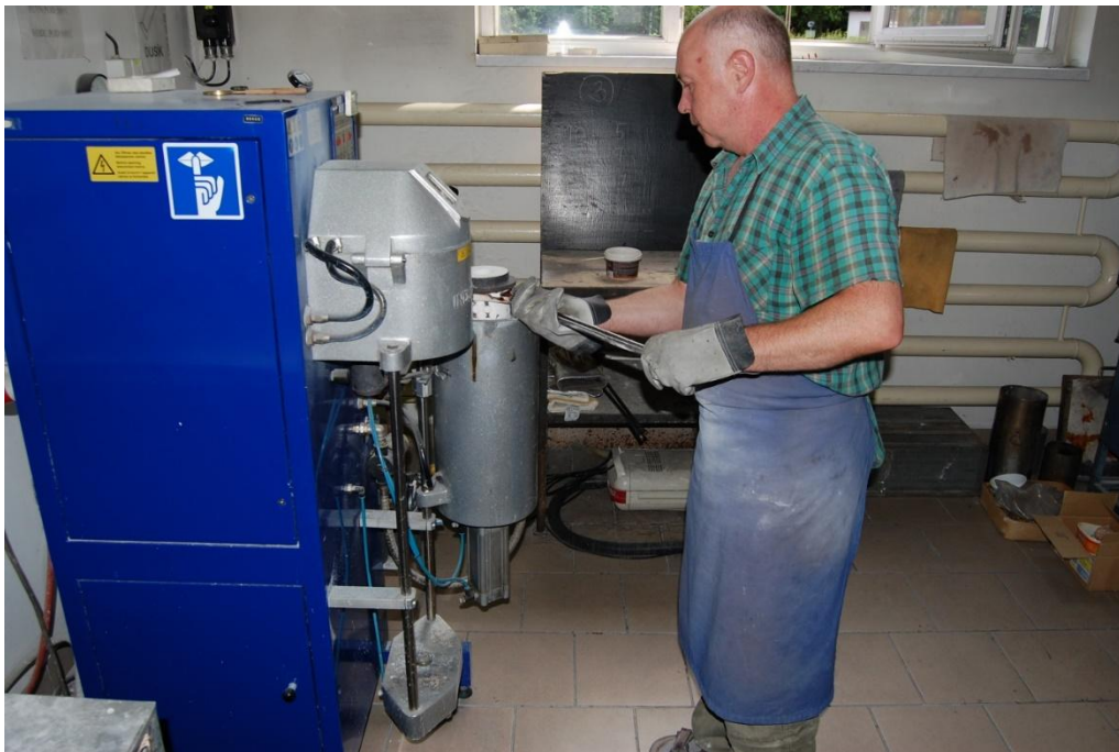
Obrázek 7: Pec určená k natavení vsázkového materiálu s vakuově uzavřeným prostorem určeným pro vlastní lití odlitku [vlastní zdroje].
