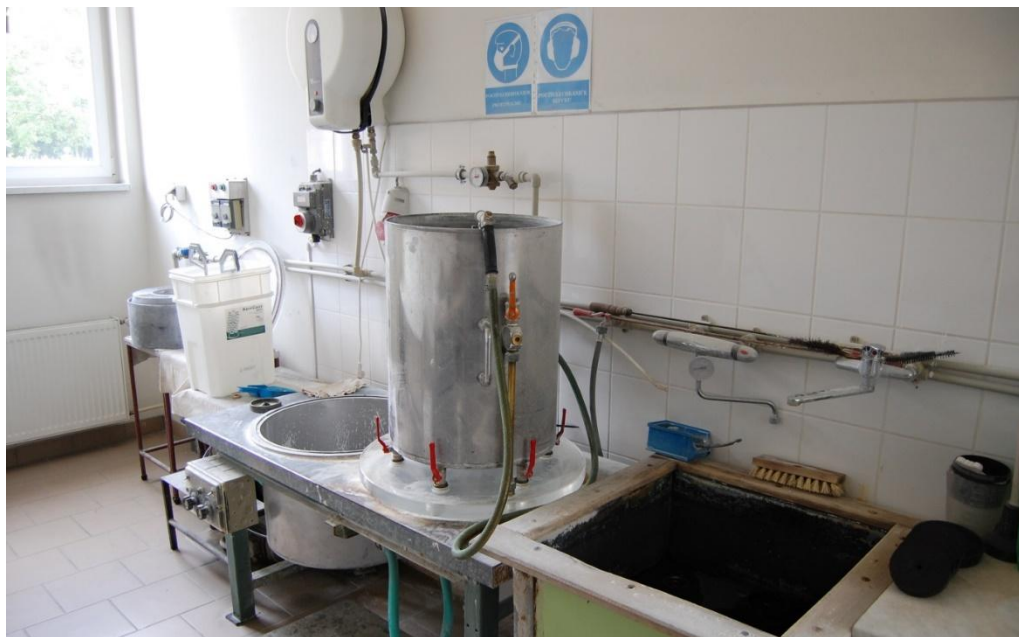
Obrázek 4: Příklad přístroje používaný k vytvoření sádrové skořepiny kolem voskového modelu [vlastní zdroj].
