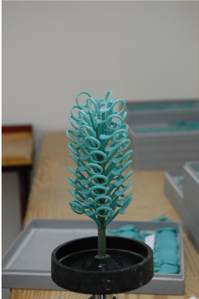
Obrázek 3: Voskový model stromečku upevněný v horní části formy[vlastní zdroje].
