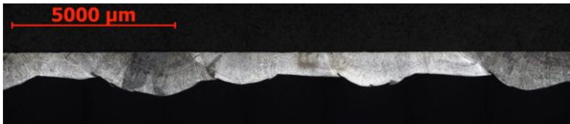
Obr. 8-9 - Příčný výbrus návaru materiálu Inconel 625, zvětšení 25x, Experiment 1
