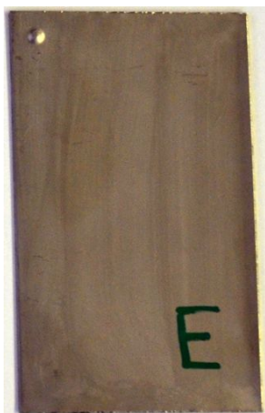
Obr. 8-6 - Materiál 316L + Cr po korozním testu
