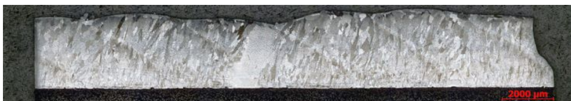
Obr. 10-3 - Příčný výbrus návaru Inconel 625, Vzorek 1 EDS, Experiment 2, zvětšení 25x
