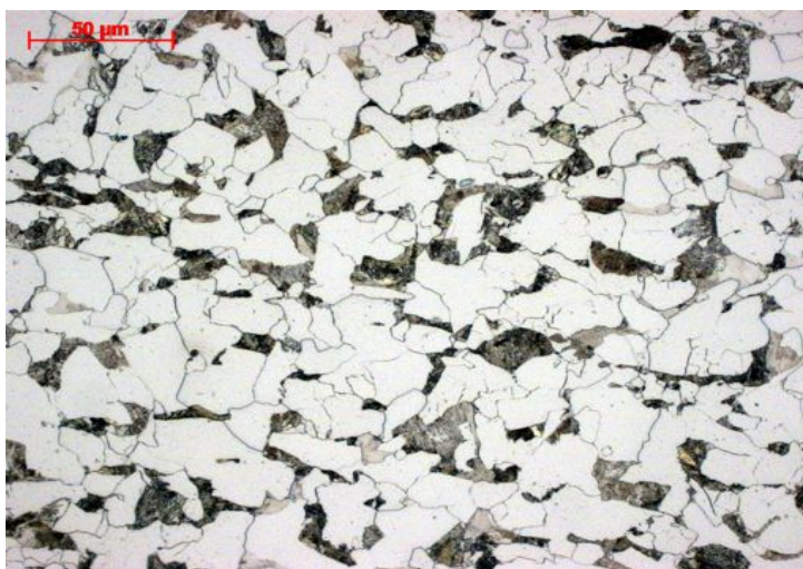
Obr. 7-1 - Feritcko – perlitická struktura oceli S355J2, zvětšení 500x
