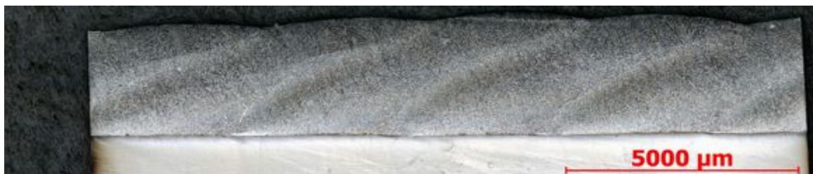
Obr. 10-6 - Příčný výbrus návaru Stellite 21, Vzorek 1 EDS, Experiment 2, zvětšení 25x
