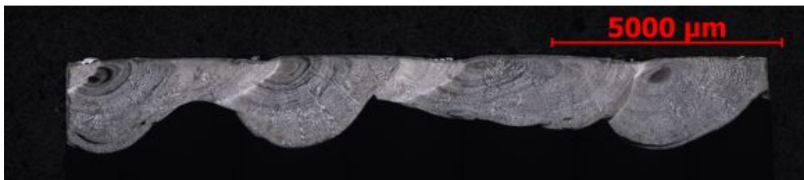
Obr. 8-8 - Příčný výbrus návaru materiálu Metco 41C, zvětšení 25x, Experiment 1
