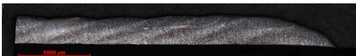
Obr. 10-6 - Příčný výbrus návaru Stellite 21, Vzorek 1 EDS, Experiment 2, zvětšení 25x
