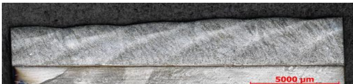
Obr. 10-8 - Příčný výbrus návaru Stellite21 , Vzorek 3 EDS, Experiment 2, zvětšení 25x
