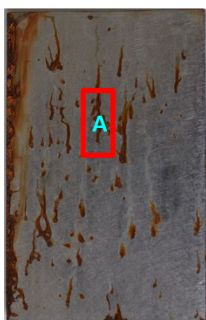
Obr. 8-4 Návar Stellite 21 po korozním testu s označením odběru vzorku
