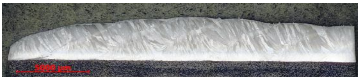
Obr. 10-5 - Příčný výbrus návaru Inconel 625, Vzorek 3 EDS, Experiment 2, zvětšení 25x
