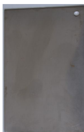
Obr. 8-5 - Materiál 316 L po korozním testu
