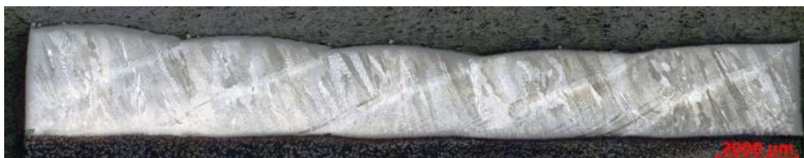
Obr. 10-4 - Příčný výbrus návaru Inconel 625, Vzorek 2 EDS, Experiment 2, zvětšení 25x
