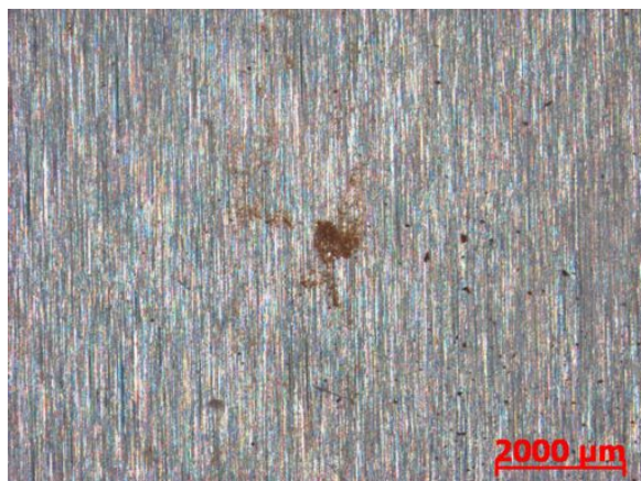
Obr. 10-2 - Korozní napadení návaru Inconel 625, experiment 2, zvětšení 50x
