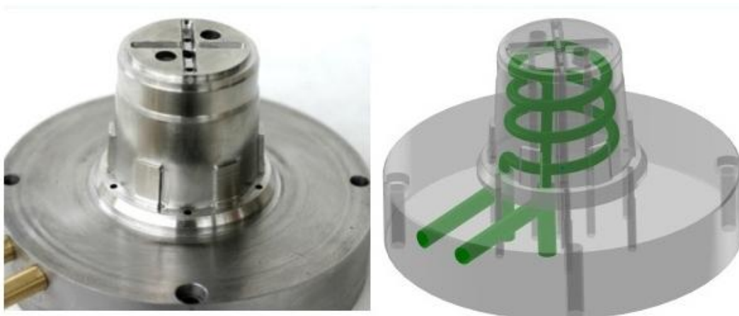
Obr.: 14 Prostorové vedení chladicích kanálů ve vložce formy[14]
