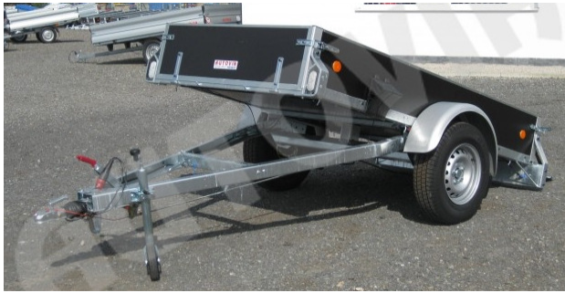
Obrázek 9: Přívěs ZV 27B skl, celková hmotnost 1300 Kg [1]
