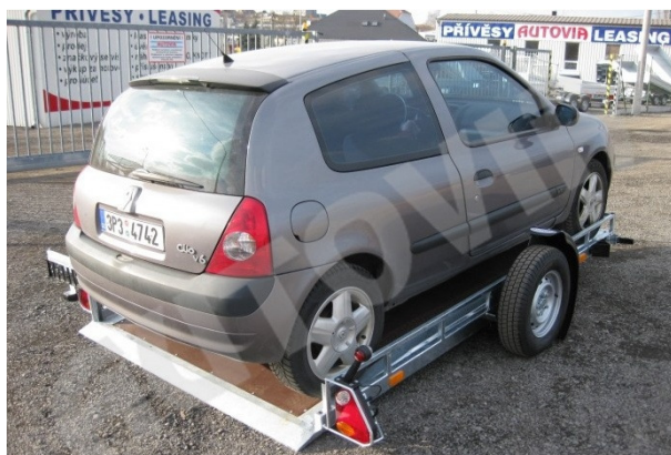
Obrázek 5: Přívěs HS 28/16 celková hmotnost 1300 kg [1]
