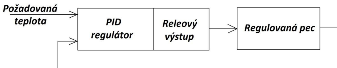
Obr 3.5 Strukturální schéma PID – reléového regulátoru
