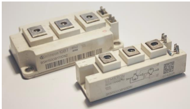
Obr. III-2 Příklady IGBT modulů, vhodných pro použití v aktivní zátěži
