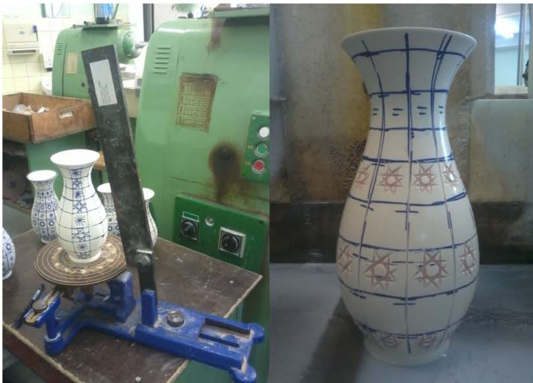
rozkreslení vázy na rozkreslovacím kroužku muřiny naznačené dvojitým kotoučem
