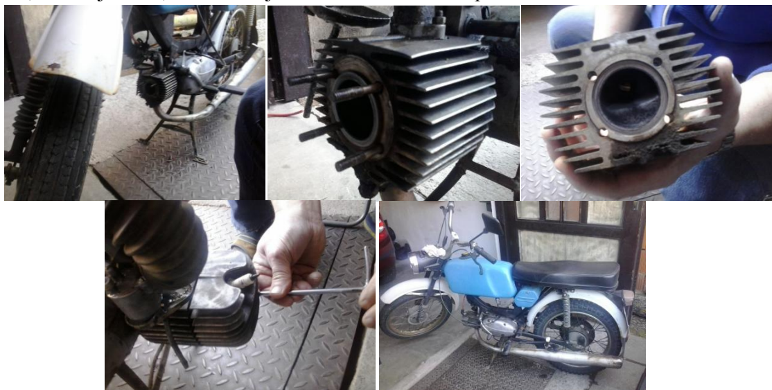
Obr. 13 – Montáž sériové hlavy na motocykl JAWA 50 Mustang
