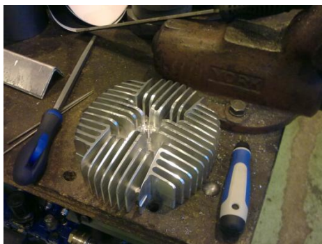
Obr. 122 – Zčištěná vějířová hlava
