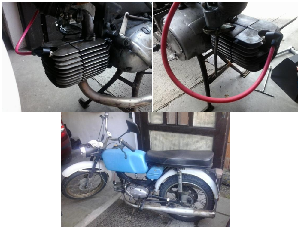
Obr. 4 – Motocykl Jawa 50 Mustang se sériově vyráběnou hlavou
