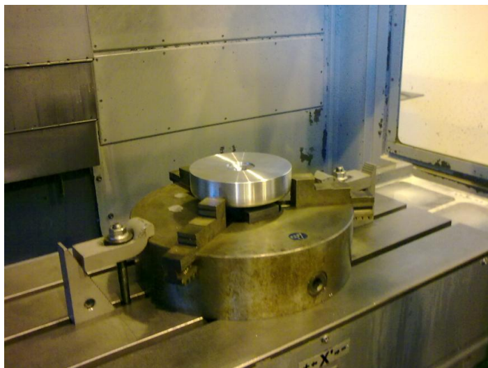
Obr. 91 – Upnutí obrobeného polotovaru ve sklíčidle, sklíčidlo upnuto pomocí upínek
