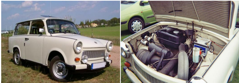
Obr. 3 – Trabant (starší automobil) - dvoutaktní, vzduchem chlazený dvouválec o výkonu 26 koní [W19]
