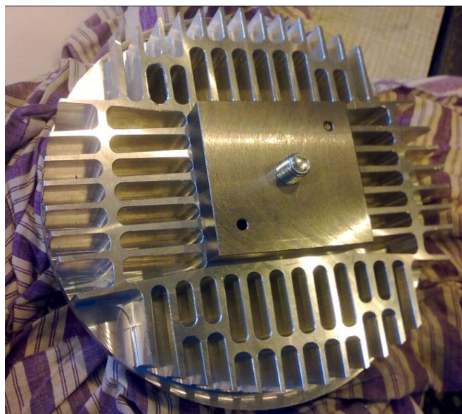
Obr. 75 – Upnutí hlavy do přípravku za spodní stranu
