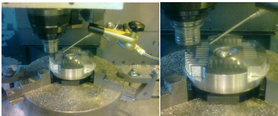
Obr. 97 – Čištění vzduchem pomocí vzduchové pistole, pistole byla uchyceno pomocí magnetického upínače na vřetenu
