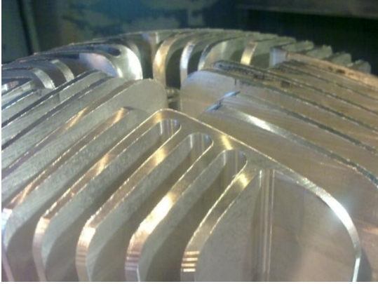
Obr. 112 – Rádus na bocích hlavy
