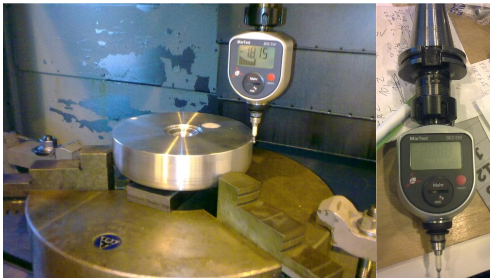
Obr. 93 – Nastavení korekcí na polotovaru pomocí sondy (vlevo), detail dotykové sondy (vpravo)
