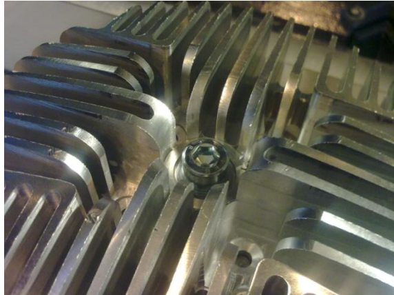
Obr. 109 – Detail upínacího šroubu M10 s podložkou 10, kterému se bylo nutno v programu vyhnout
