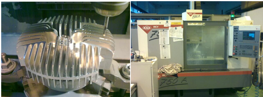
Obr. 110 – Posledních 5 mm materiálu k odebrání
