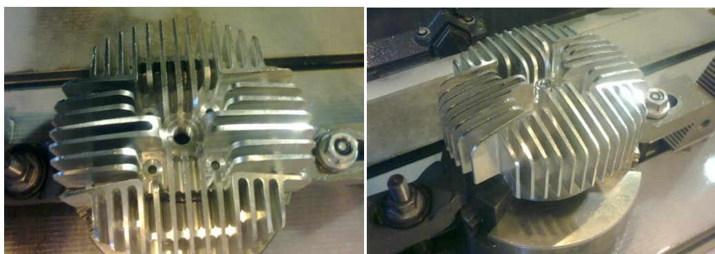
Obr. 119 – Hlava po dokončení všech operací
