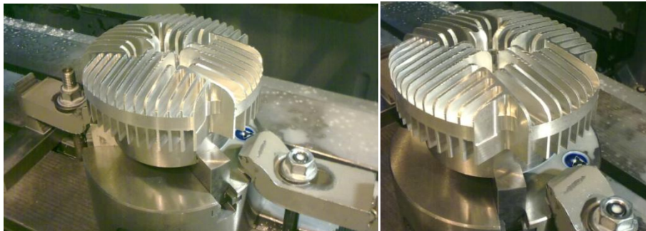
Obr. 107 – Obrobení drážek pomocí frézy průměru 6 mm do hloubky 22 mm
