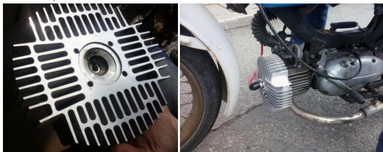
Obr. 132 – Namontovaná Vějířová hlava na motocyklu JAWA 50
