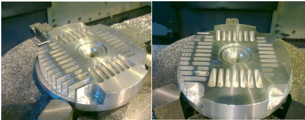
Obr. 96 – Frézování drážek a vybrání na spodní straně hlavy pomocí frézy průměru 6 mm do hloubky 22 mm
