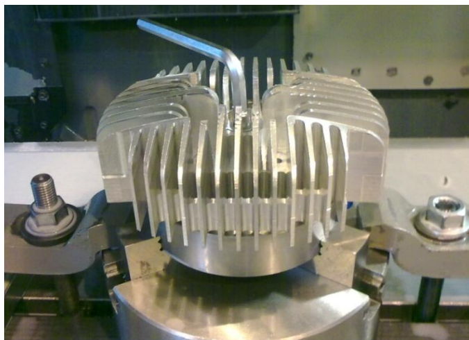
Obr. 117 – Uvolnění šroubu M10 pomocí imbusového klíče
