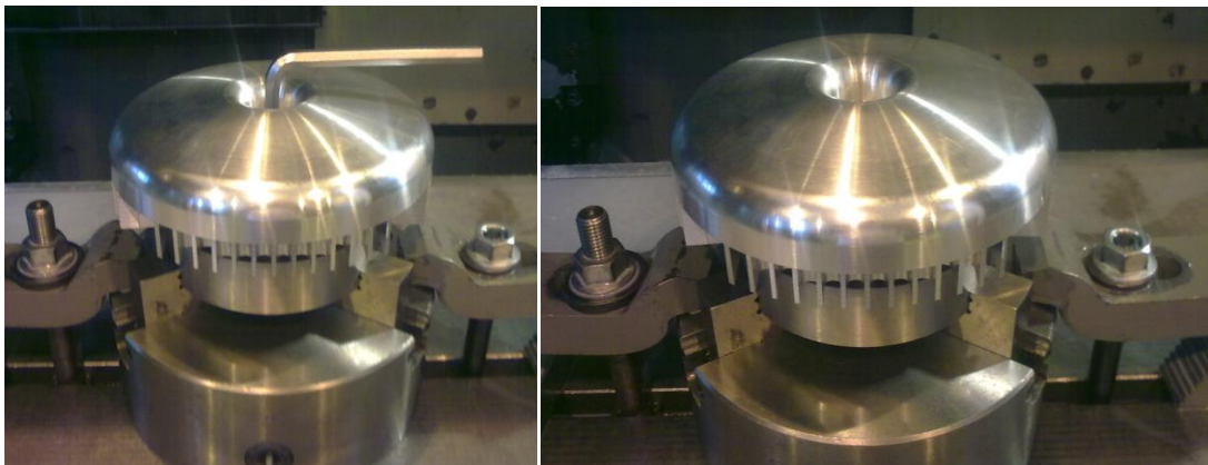
Obr. 105 – Upnutí hlavy do přípravku pomocí imbusového klíče
