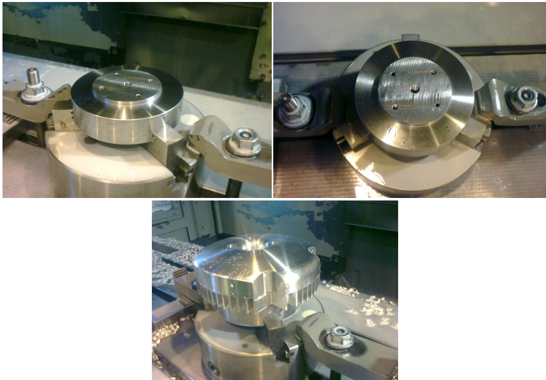
Obr. 83 – Upnutí inovovaného přípravku do upínací desky
