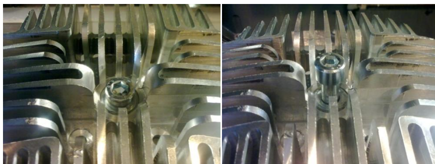
Obr. 118 – Vyndání šroubu M10 a podložky 10
