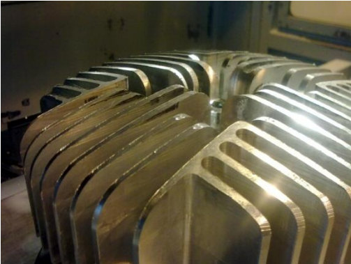
Obr. 114 – Dokončení všech zaoblení na hlavě rádiusovou frérou průměru 6 mm
