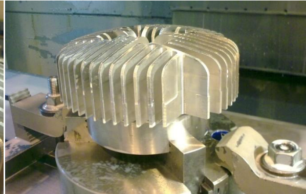
Obr. 114 – Dokončení všech zaoblení na hlavě rádiusovou frérou průměru 6 mm
