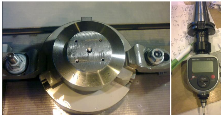
Obr. 104 – Korekce inovovaného přípravku pomocí dotykové sondy
