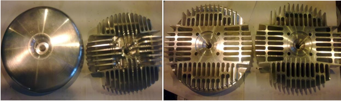
Obr. 120 – Vlevo: Obrobená hlava z přední strany, Vpravo: Obrobená hlava ze zadní strany
