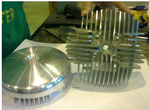
Obr. 121 – Ukázka celé obrobené hlavy
