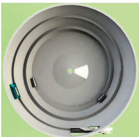
Obr. 4-20 – Půdorysný pohled na nádobu kruhového zásobníku
