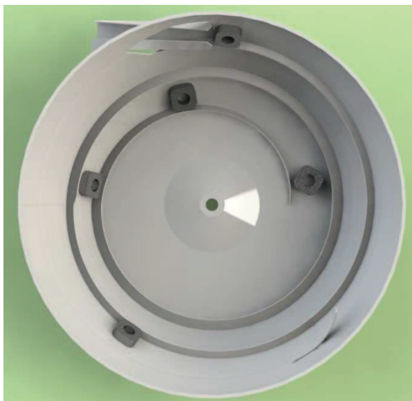
Obr. 4-7 - Půdorysný pohled na nádobu kruhového zásobníku
