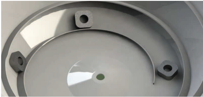
Obr. 4-4 - Nabírací závity s překloupěním dílu do pláště
