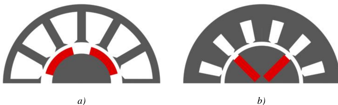
Obr. 3.1 Uspořádání permanentních magnetů na rotoru:
