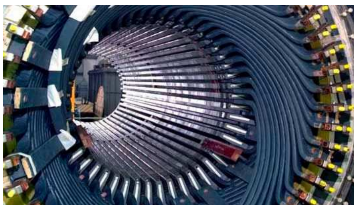
Obr. 3.1: Stator turbogenerátoru při výrobě
