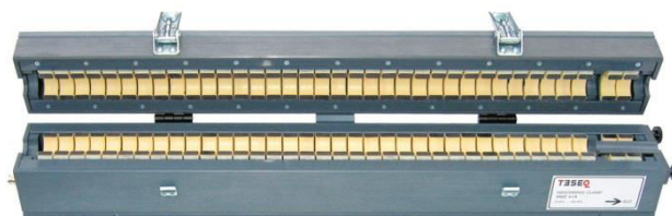
obr. P4 absorpční kleště AMZ 41 (30 MHz – 1 GHz) [9]
