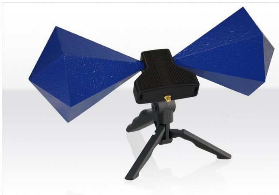
obr. P6 Bikónická anténa BicoLOG 20300 (20 MHz – 3 GHz) [6]
