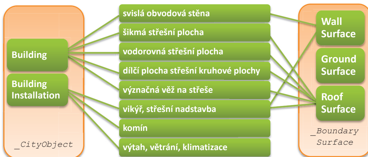
obr. 3.5 Schéma mapování tříd vstupních dat na třídy CityGML pro budovy
